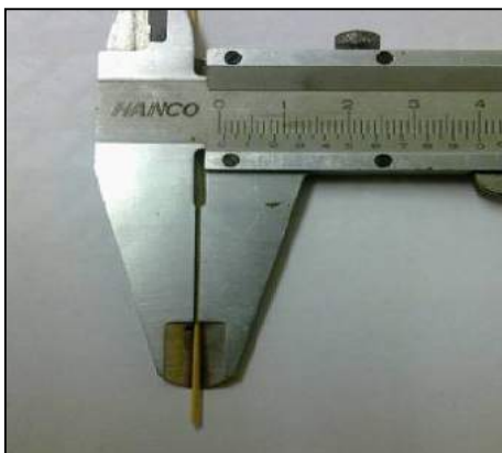
Idayametha engafanele esiphethweni esiyisidunu: okungu-1mm.
